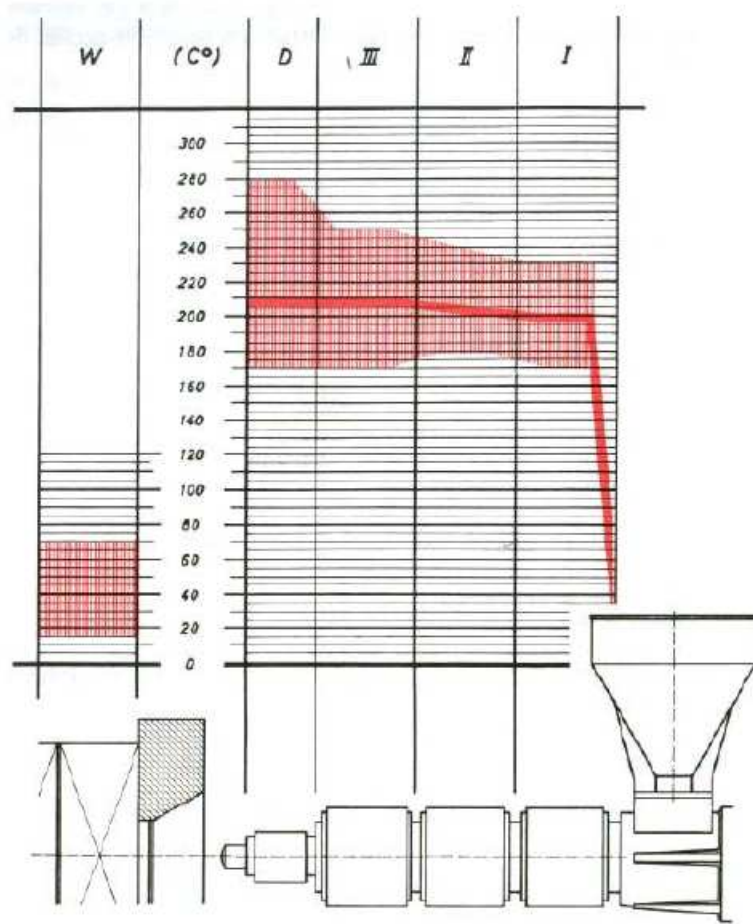
Figura 5.23: Temperaturas de trabajo del husillo del PS
