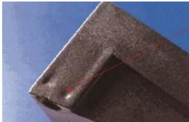
Figura 5.18: Error por depresiones superficiales
