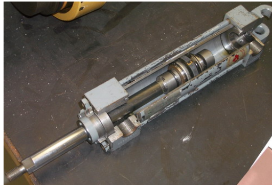
Figura 2.6: Composición de un pistón hidráulico
