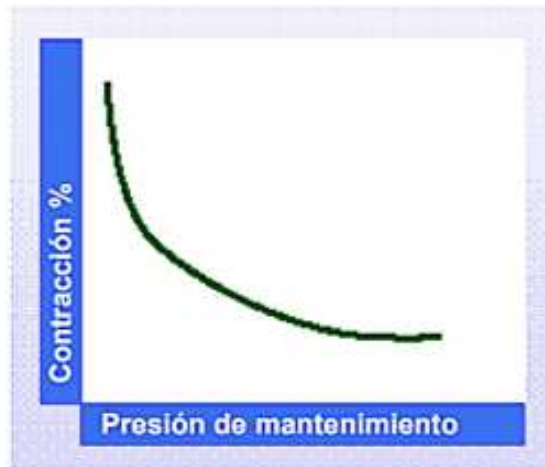
Figura 5.4: Relación presión de mantenimiento y contraccion
