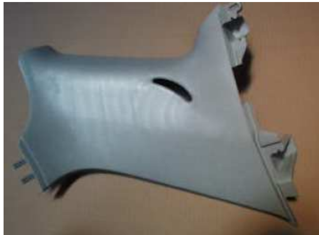
Figura 5.14: Error por diferencias de brillo; principalmente en las esquinas
