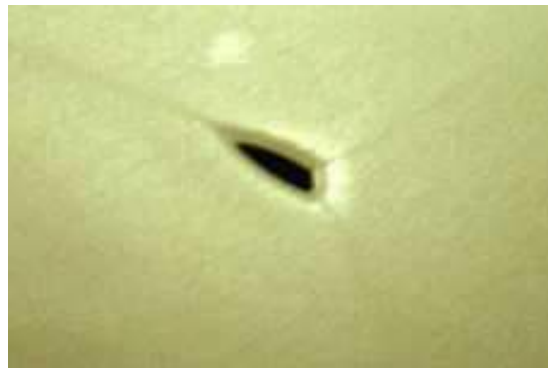
Figura 5.19: Error por atrapamientos de aire en la pieza
