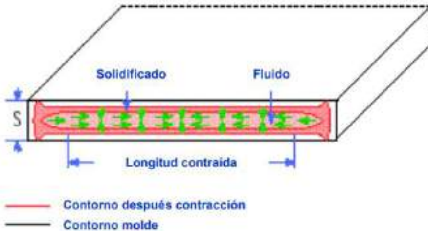
Figura 5.2: Representación de las contracciones en una pieza
