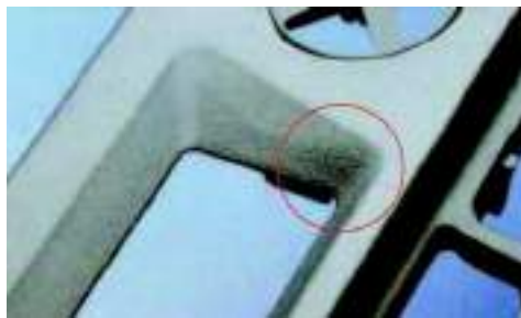
Figura 5.15: Error por diferencias de brillo; principalmente en las esquinas
