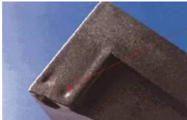
Figura 5.18: Error por depresiones superficiales
