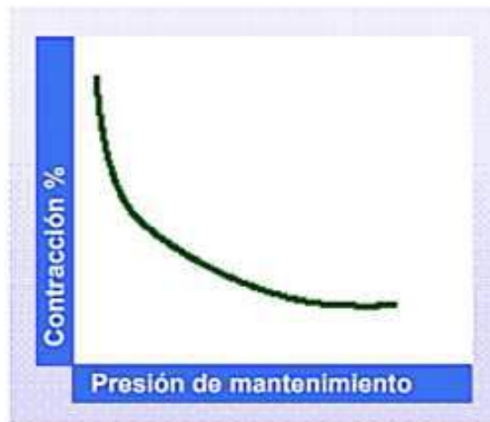
Figura 5.4: Relación presión de mantenimiento y contraccion
