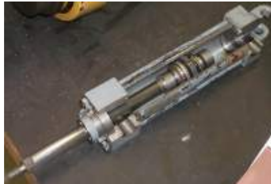
Figura 2.6: Composición de un pistón hidráulico
